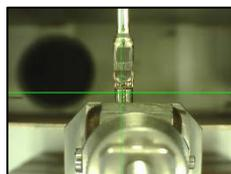
可观察断面分析软件并通过旋转旋钮调整准确的切割位置。
