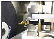
搭载伺服电机移送夹具进行全自动切割和抛光。杜绝人为操作误差。
