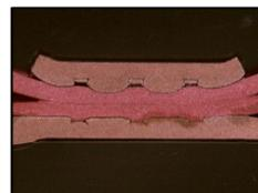
无需树脂固化端子即可制作纵断面样品。使用专用刀片和夹具可对应 0.18sq~2sq 电线尺寸。
