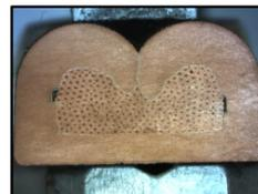
5sq~最大 60sq 的极粗线也可对应。通过真空装置吸收粉尘后，切割后无需抛光即可观察清晰断面。（极粗线对应为选配）
