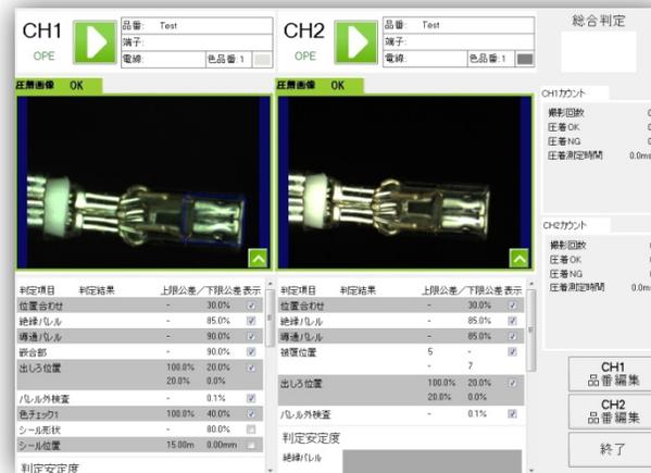
在自动压着机的电线搬送路径中安装上高速快门摄像头（带有小型闪光照明）。在移动过程中不需要停止就可以对所有压着状态进行图像检查。
